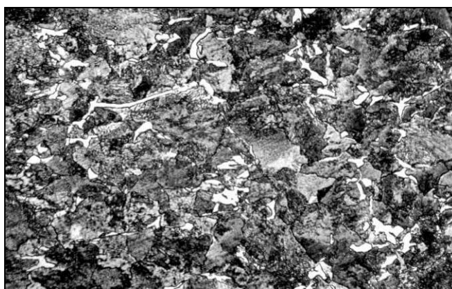
Рис. 6.27. Микроструктура металла обода колеса (текущая технология, заготовка \varnothing 415 мм). \times 400 .
