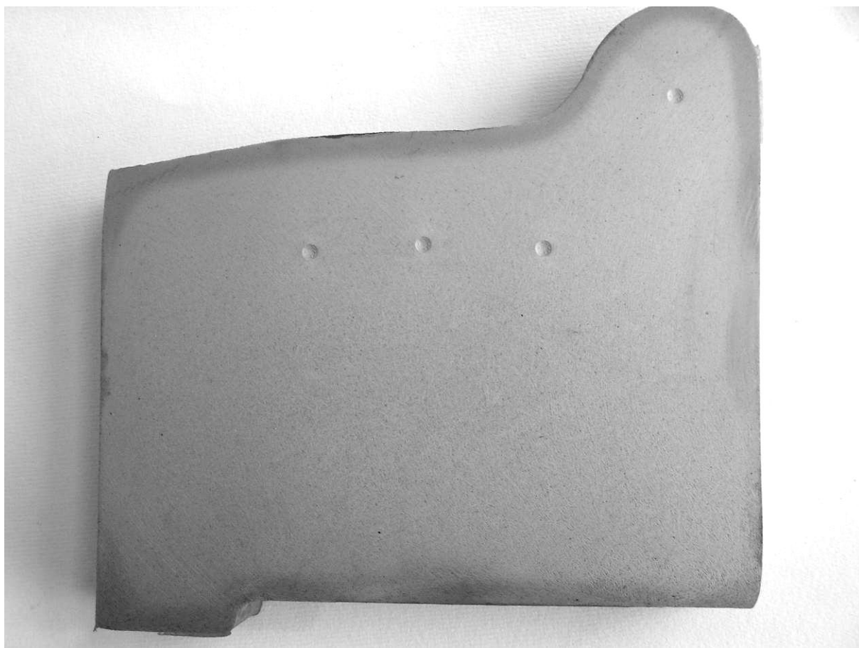
Рис. 7.11. Макроструктура бандажа № «3» без ПФО (плавка 22670)
