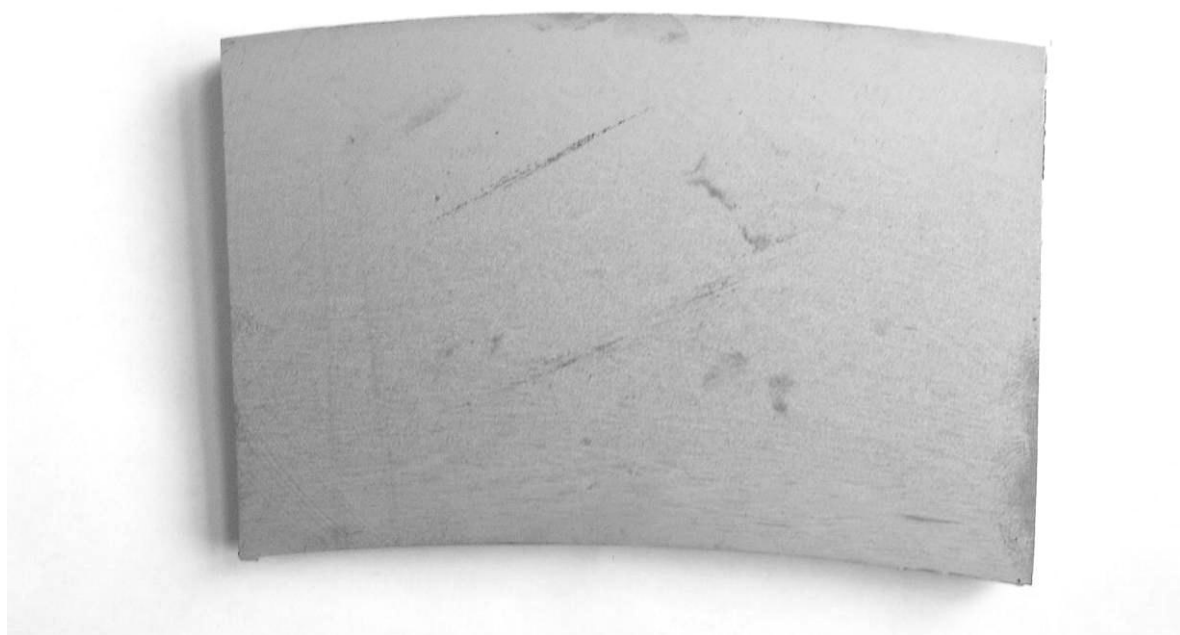
Рис. 7.25. Макроструктура поперечного (а) и продольного (б) темплетов бандажа №4355 опытной вакуумированной плавки №51124 без ПФО
