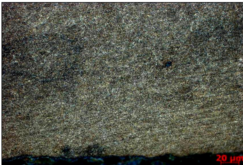
Рис. 5.16. Микроструктура поверхностного слоя обода колеса после эксплуатации
