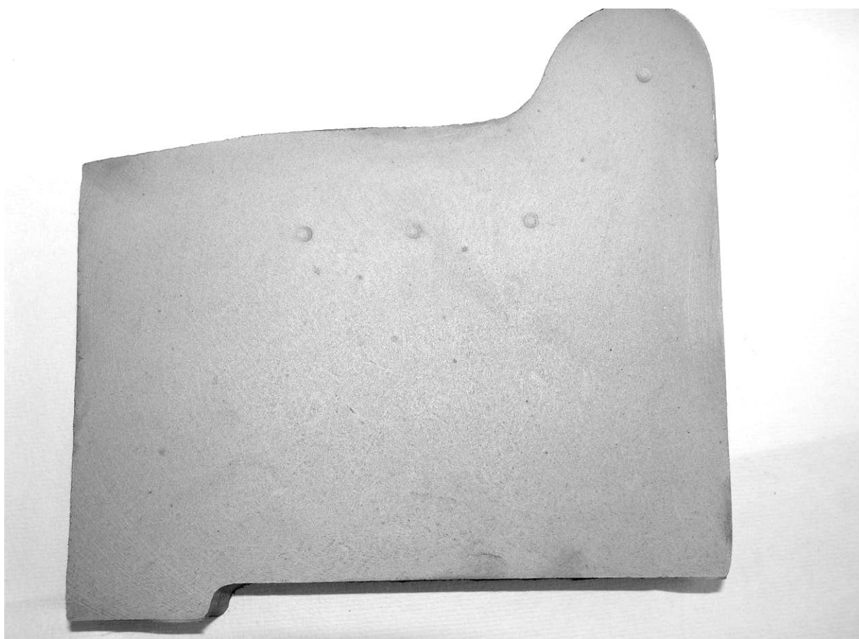
Рис. 7.9. Макроструктура биндажа № «1» без ПФО (плавка 22675)
