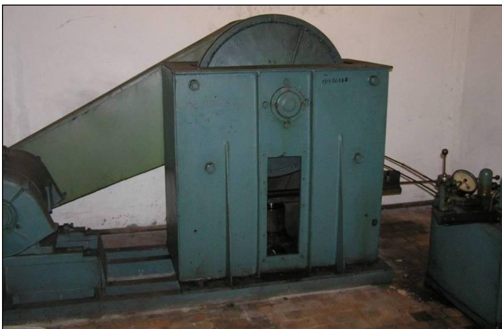
Рис. 2.6. Стенд для моделирования торможения в зоне контакта «колесо-рельс»
