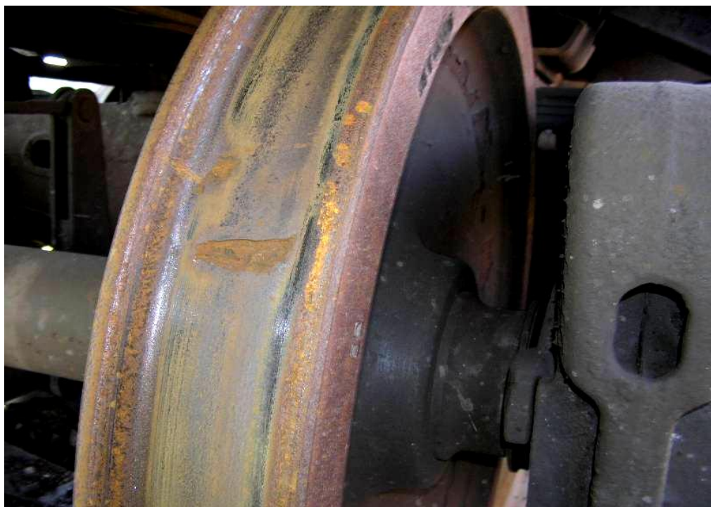
Рис. 5.10. Внешний вид колеса с дефектами на поверхности катания (пл. 21125)
