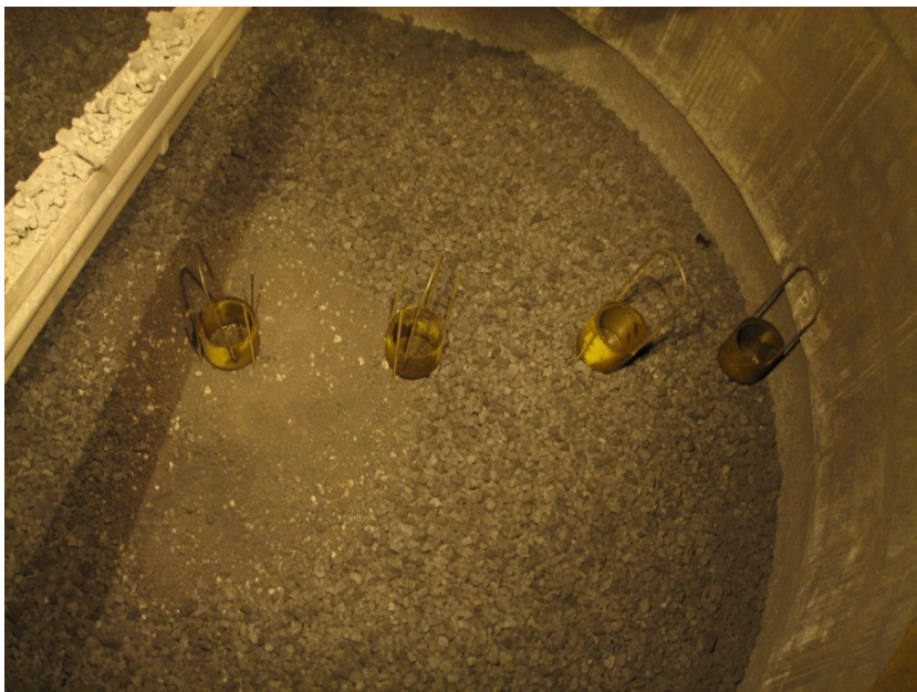
Рис. 2.15. Встановлення циліндричних пробовідбирачів на поверхні коксу перед вивантаженням дослідницької залізовмісної порції АОШ 9-4
