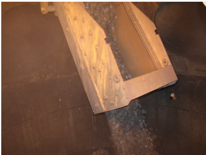
Рис. 2.9. Вивантаження порції коксу масою 10,6 т, \alpha_{из} = 72\% , кут нахилу лотка 28,2^\circ
