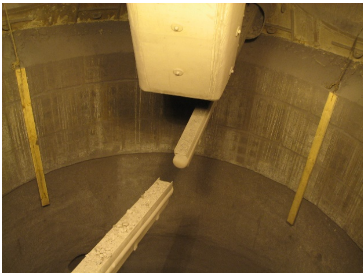
Рис. 2.11. Дерев'яні рейки, опущені через газовідводи для визначення точок зустрічі потоку шихти з плитами колошникової захисту
