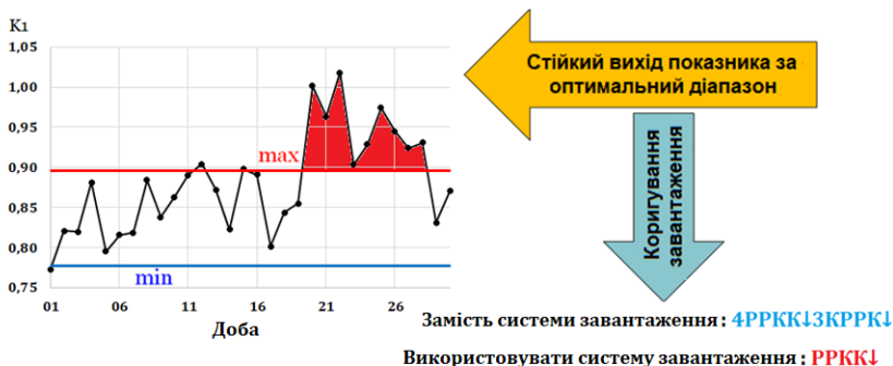
Рис. 4.18. Відеокадр експертного модуля з управління завантаженням ДП №9 з КЗП
