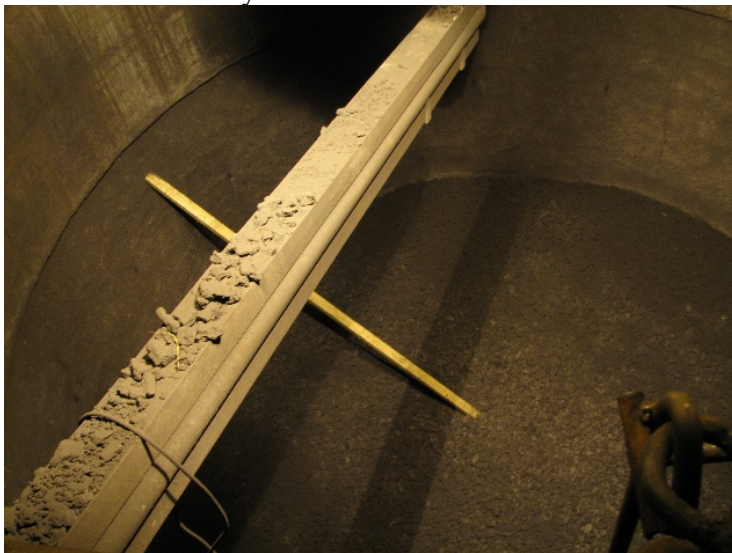
Рис. 2.12. Дерев'яний брус, встановлений похило на поверхні засипу шихти для визначення точок зустрічі потоку шихти з поверхнею засипу шихти
