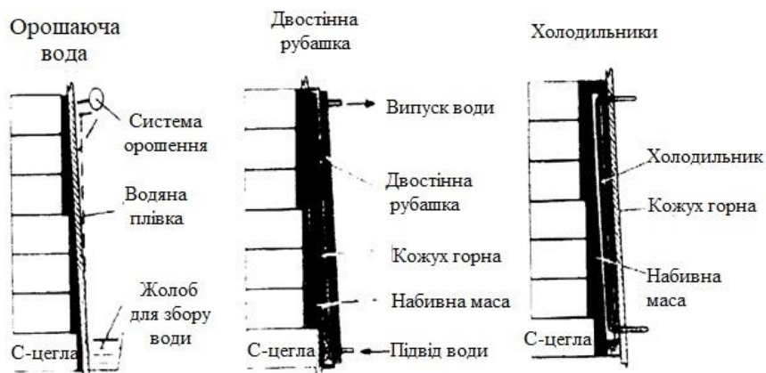
Рис. 1.3 – Конструкції систем охолодження горну доменних печей
